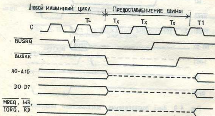
Рис. 4.8. Цикл предоставления доступа к шине
