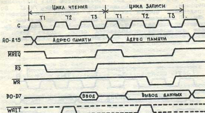
Рис. 4.4. Цикл чтения из памяти и цикла записи в память
